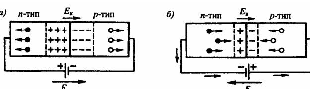
положно полю контактного слоя (б), то перемещение электронов и дырок приведет к сужению контактного слоя и его сопротивление уменьшится – такое направление называется **пропускным (прямым)**.
