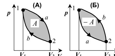
**Круговым процессом** (или **циклом**) называется процесс, при котором система, пройдя через ряд состояний, возвращается в исходное состояние. На  $(p, V)$ -диаграмме цикл изображается замкнутой кривой, где участок 1–2 соответствует расширению, а 2–1 – сжатию газа.
